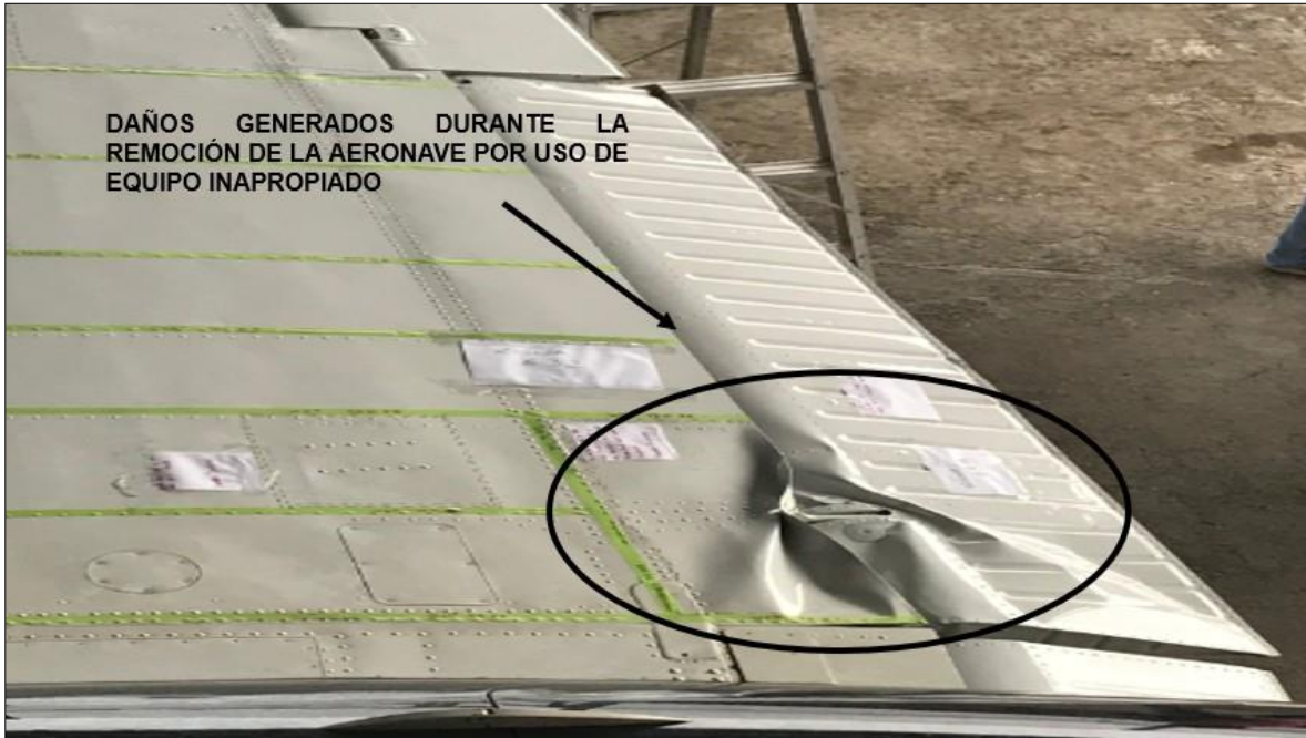
Fotografía No. 5: daños en el plano derecho causados durante la remoción de la aeronave.
