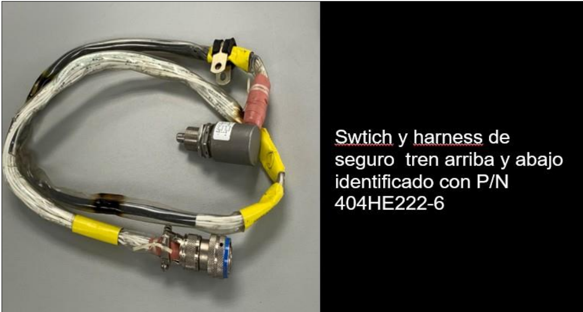
Fotografía No. 14: arnés eléctrico e interruptor del sistema arriba y abajo del tren derecho.
