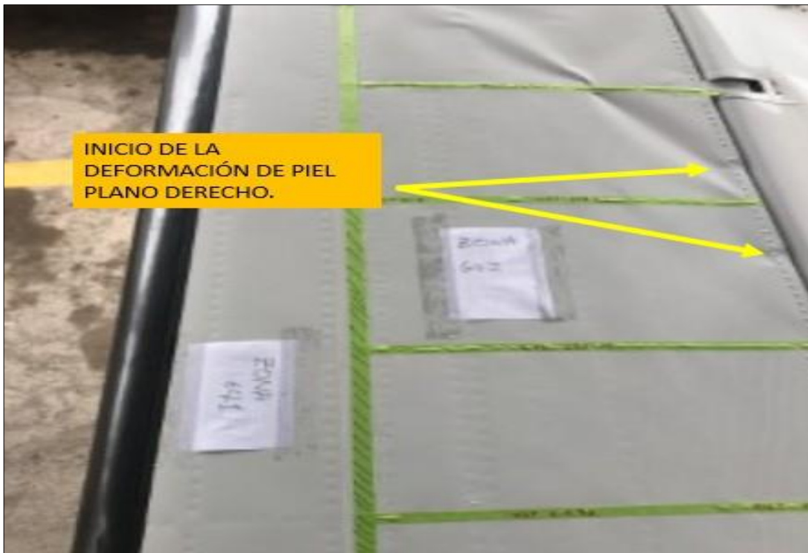
Fotografía No. 4: deformación de la piel, plano derecho.
