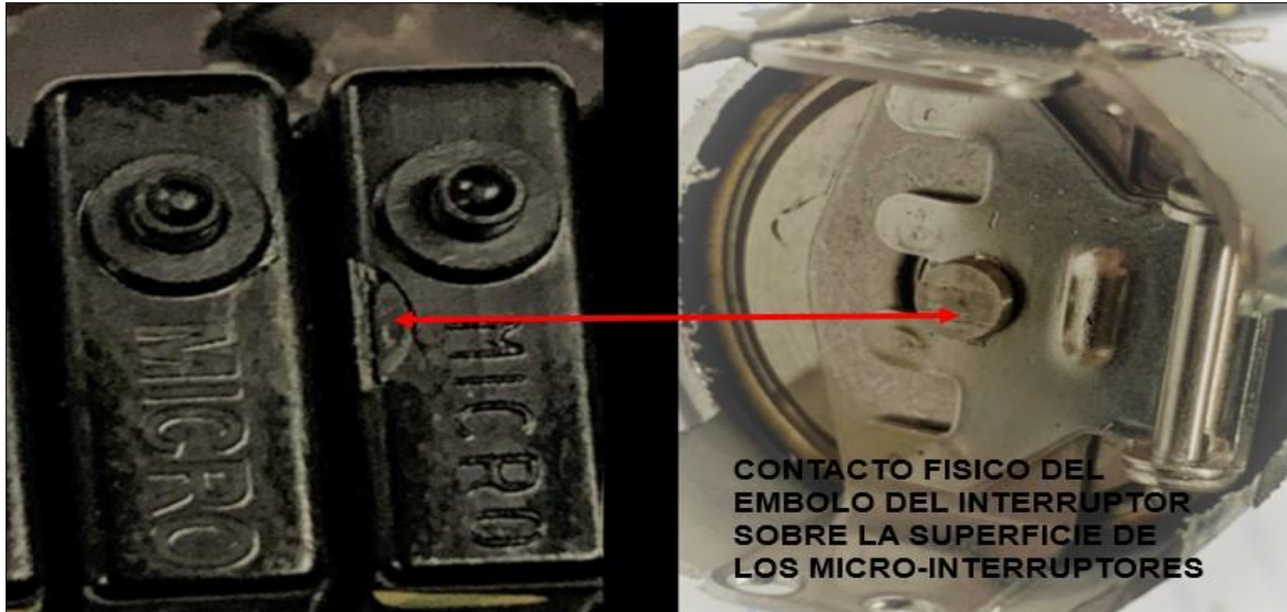
Fotografía No. 25: marcas del obturador del “downlock switch” sobre los micro interruptor.
